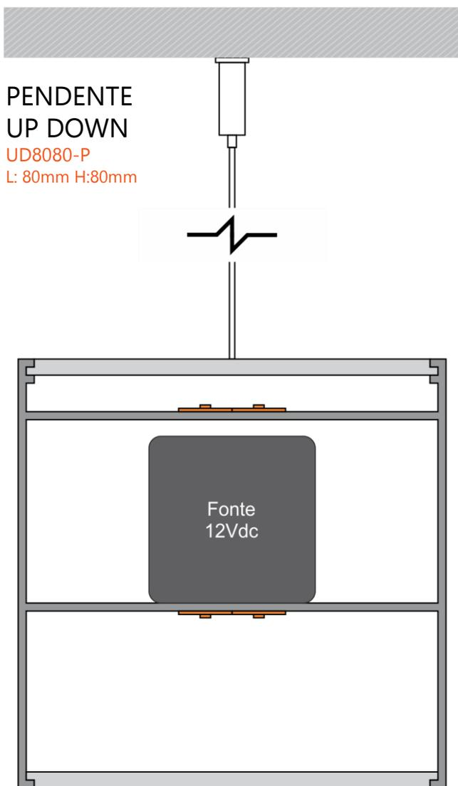
O pendente UP Down foi projetado para iluminar em duas direções, com acendimento independente possibilita potência e temperatura de cor diferentes em cada uma. Com fontes embutidas, pode ser ligado direto na rede 110, 220V ou ainda em um circuito dimerizável.
